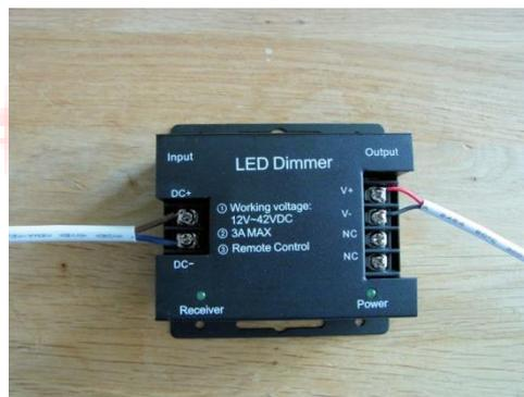
Das Kabel mit dem Stecker mit Output des Controllers verbinden. ACHTUNG: auf richtige Polung achten (s. Bilder)
