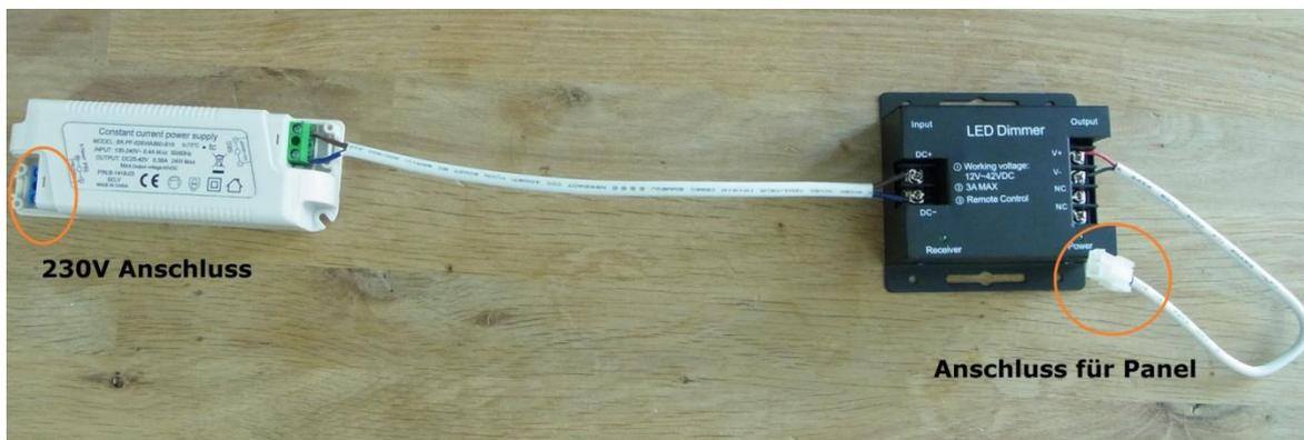
Stecker am Panel einstecken und Driver mit Netzspannung versorgen (230V).
